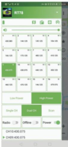
Appuyez longuement sur un canal et sélectionnez Modifier le canal pour modifier les paramètres du canal.
