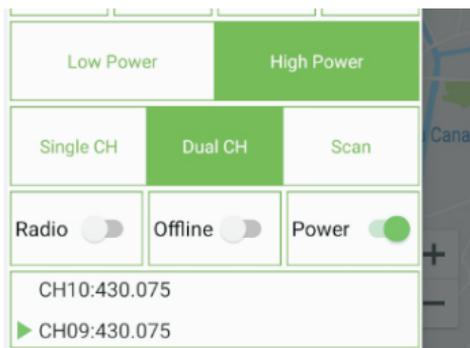
Abra la aplicación móvil, haga clic en la sección [Encendido] y gírela a gris para apagar la radio del automóvil. La próxima vez que necesite encenderlo, abra la aplicación y la parte [Encendido] se iluminará y podrá usarla normalmente.
