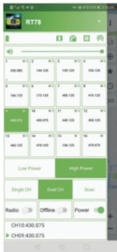
Premere a lungo su un canale e selezionare Modifica canale per modificare i parametri del canale.
